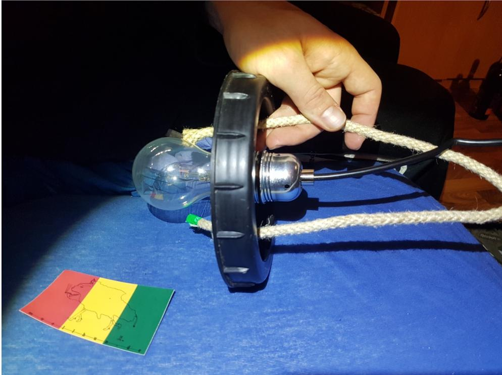
kabel der fassung und kabel aus der decke (stromanschluss)mittels 2 wago-klemmen verbinden (bei vorhergehender sicherstellung der spannungsfreiheit und gegen wiedereinschalten sichern)
