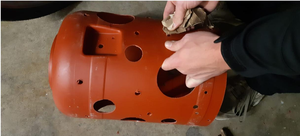
muellampenschirm abkleben (hierzu am besten das goasmaßband verwenden) und anschließend besprayen
